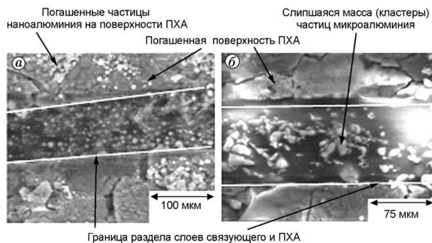
Рис. 4. Изображения со сканирующего электронного микроскопа сэндвичей, погашенных при давлении 2 МПа:
