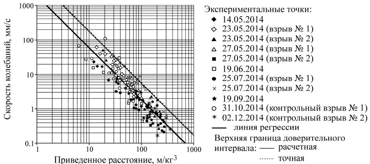
Рис. 2. Регрессия для Талдинского угольного разреза (ОАО “УК “Кузбассразрезуголь”)
