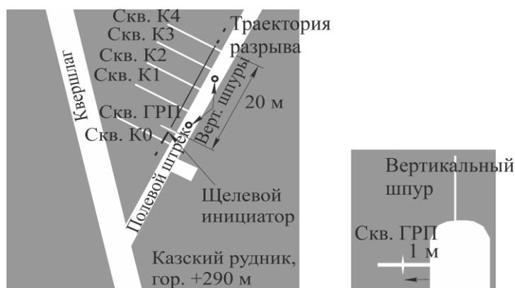
Рис. 12. Схема расположения скважины гидроразрыва и контрольных скважин К0-К4 в натурном эксперименте
