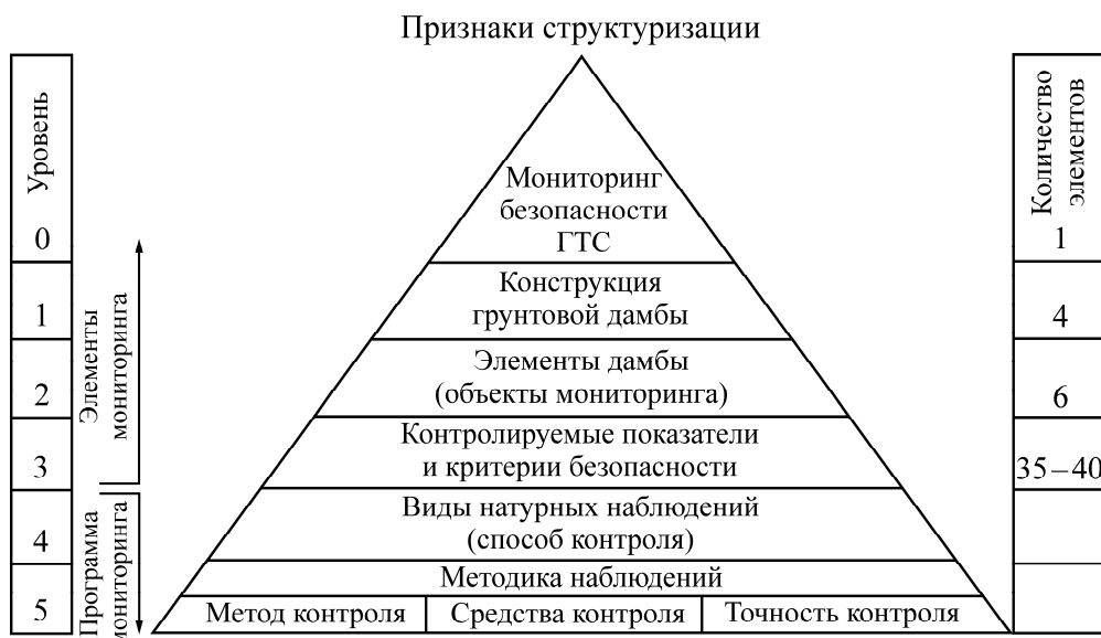
Рис. 1. Схема структуризации системы мониторинга безопасности ГТС
