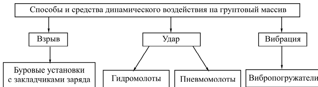
Рис. 1. Способы и средства механической разработки грунта
