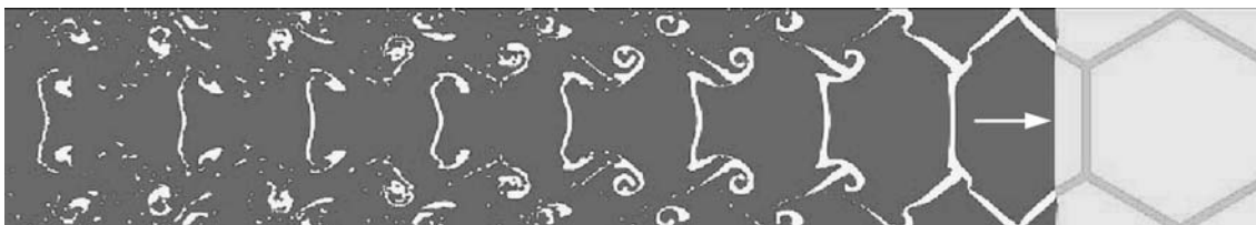
Рис. 1. Гидродинамическая картина разрушения структуры эмульсии за фронтом ударной волны амплитудой 20 ГПа (двумерная модель):
