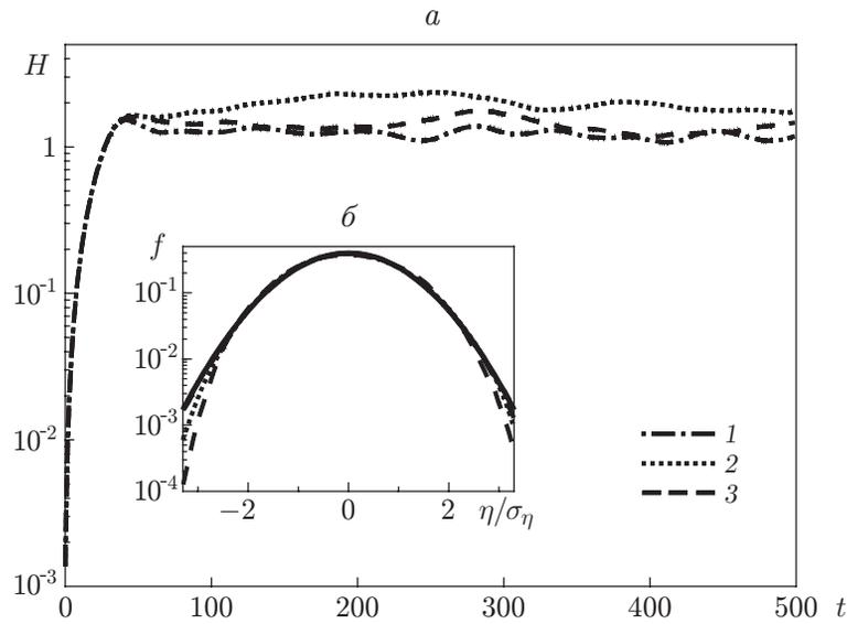
Рис. 1. Зависимости полной энергии системы от времени (а) и функции плотности вероятности  $f$  от относительной амплитуды поверхности (б) при различных значениях напряженности внешнего электрического поля:
