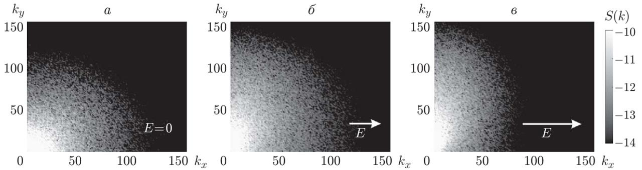
Рис. 3. Фурье-спектры профиля поверхности жидкости  $\log(|\eta(k_x, k_y)|)$  в квази-стационарном состоянии при различных значениях безразмерной напряженности электрического поля:
