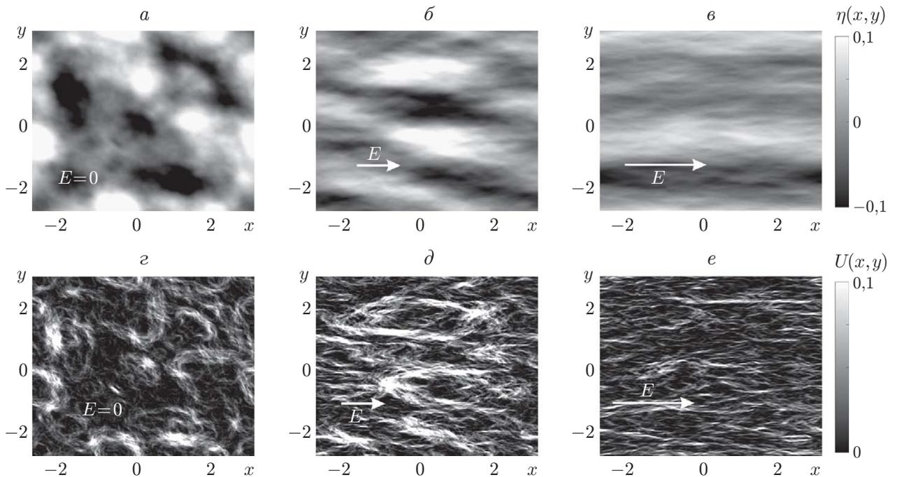
Рис. 2. Формы поверхности жидкости (а-в) и распределения потенциальной энергии на границе жидкости (z-e) в некоторые моменты времени квазистационарного движения при различных значениях безразмерной напряженности электрического поля:
