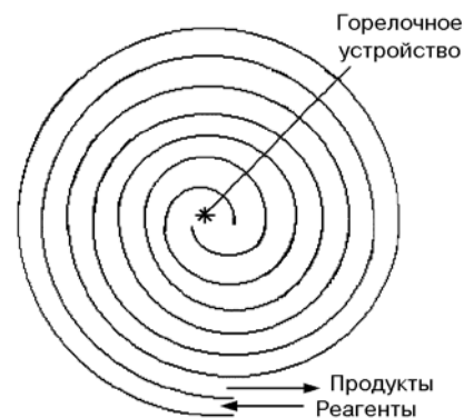
Рис. 3. Регенеративная горелка с двойной спиралью
