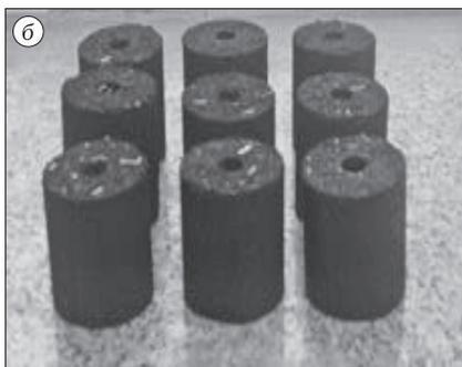
Рис. 6. Гидравлический брикетный пресс (ИХХТ МАН, Монголия) (а) и внешний вид угольных брикетов, полученных на нем (б).
