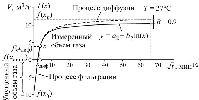
Рис. 2. Зависимость объема выделившегося метана  $V$  от  $\sqrt{t}$
