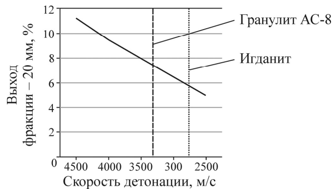
Рис. 4. Зависимость выхода фракции -20 мм от скорости детонации гранулированных ВВ при шпуровой отбойке кварца Кыштымского месторождения
