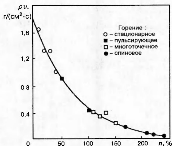
Зависимость массовой скорости горения состава \text{Fe}_2\text{O}_3 + \text{Zr} + n\text{ZrO}_2 с газообразующей добавкой \text{MoO}_3 от степени разбавления ( m = 40\% )
