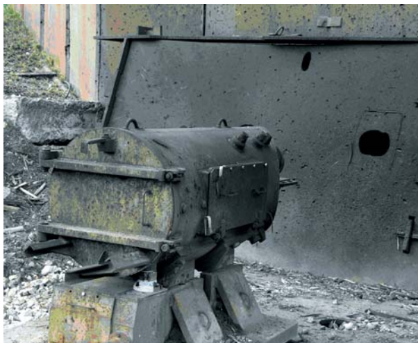
Рис. 8. Взрывозащищенная камера, используемая для размещения регистраторов изображений при проведении взрывных экспериментов
