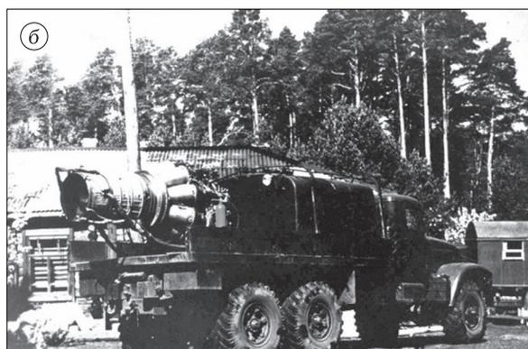
Рис. 4. Мощный аэрозольный генератор на базе гусеничного плавающего транспортера ПТС (а) и колесного транспортного средства (б).
