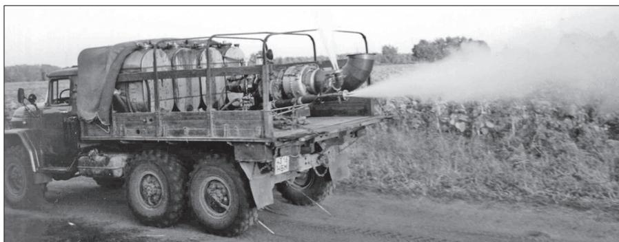
Рис. 5. Генератор аэрозолей регулируемой дисперсности.
