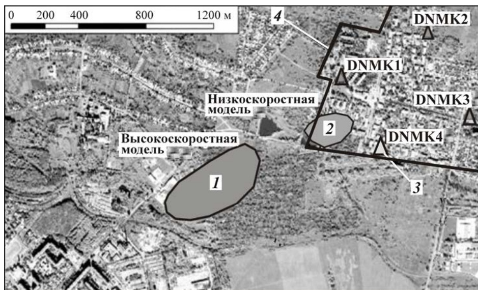
Рис. 1. Предполагаемые зоны источников техногенной сейсмичности на исследуемом участке: 1 — высокоскоростная модель; 2 — низкоскоростная модель; 2 — станция наблюдения “Ермак-5”; 3 — первоначальная граница проведения сейсмического мониторинга
