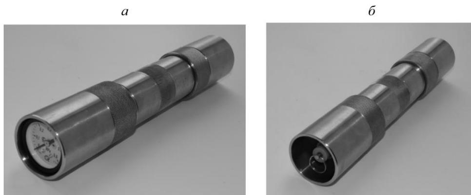
Рис. 6. Контейнер для транспортировки керна: *а* — вид спереди; *б* — вид сзади
