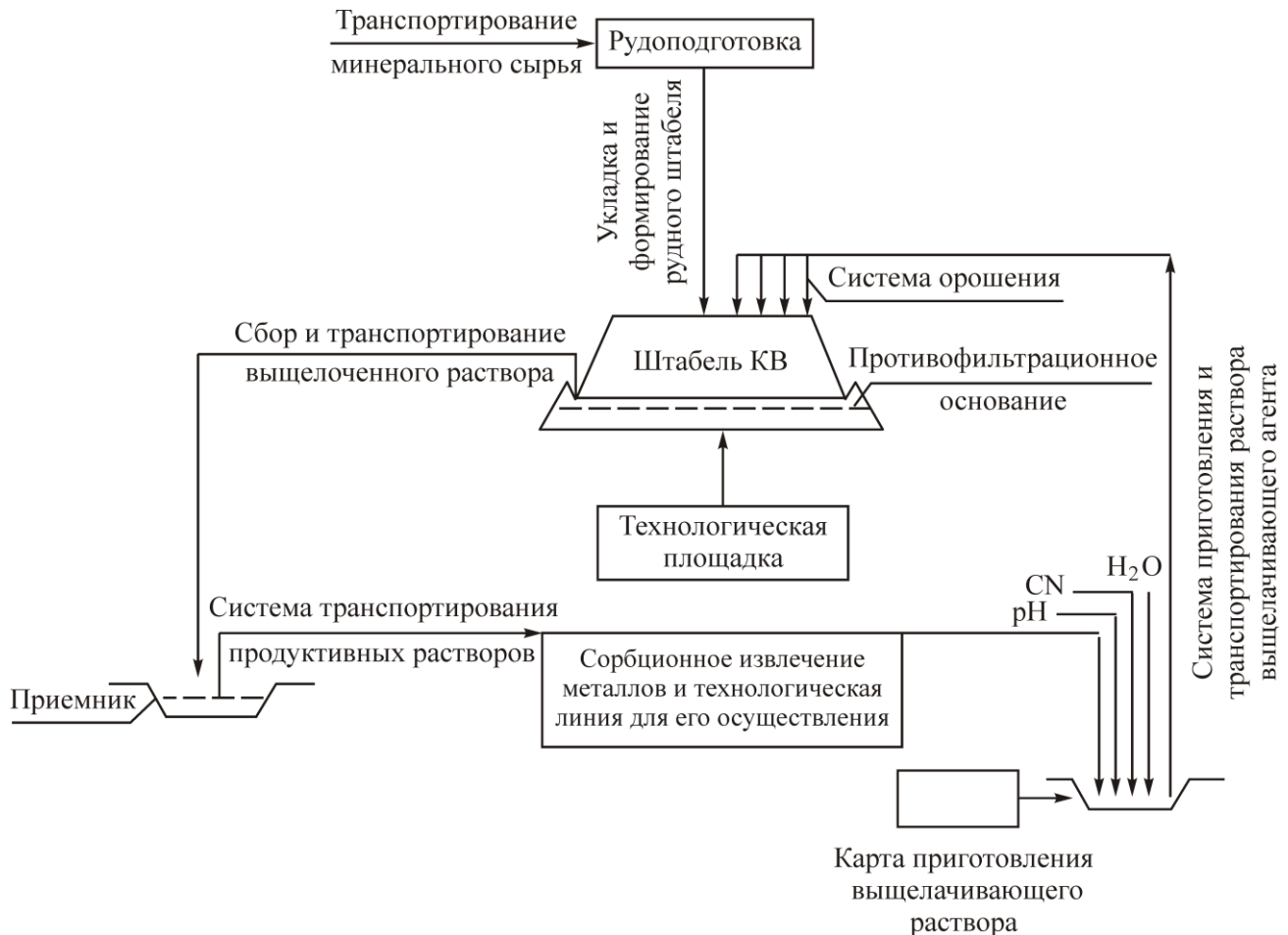
Рис. 1. Принципиальная схема физико-химической геотехнологии наземного кучного выщелачивания металлов
