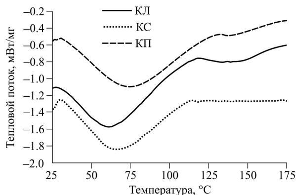
**Рис. 5.** ДСК-кривые неизотермической сушки коры лиственницы, сосны и пихты в воздушной атмосфере. Скорость нагрева 10 °С/мин.
