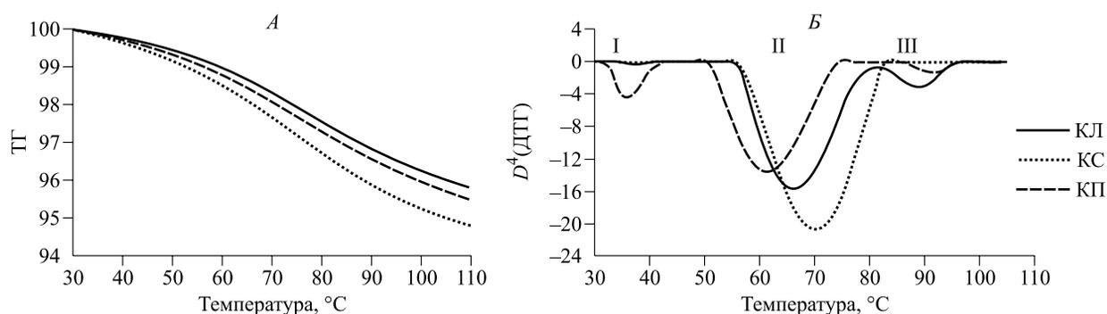
**Рис. 3.** Зависимости потери влаги корой от температуры при скорости нагрева 10 °С · мин<sup>-1</sup> в атмосфере воздуха (А) и функция  $f(t) = d^4(\text{ДТГ})/dt^4$ , I–III – «фракции» десорбирующей воды (Б).
