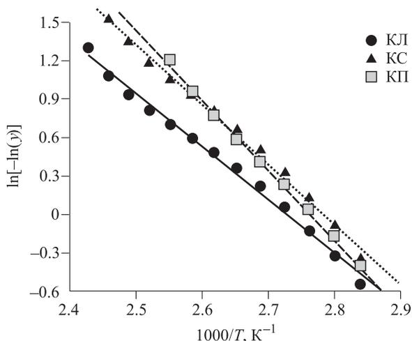
**Рис. 4.** Зависимость потери влаги образцами коры при нагреве в атмосфере воздуха со скоростью 10 °С/мин в координатах уравнения А. Broido (1969): кора лиственницы:  $y = -4.4415x + 12.062$ ,  $R^2 = 0.987$ ;  $E_a = 36.91$  кДж/моль; кора сосны:  $y = -4.9802x + 13.795$ ,  $R^2 = 0.989$ ;  $E_a = 41.39$  кДж/моль; кора пихты:  $y = -5.7245x + 15.791$ ,  $R^2 = 0.995$ ;  $E_a = 47.57$  кДж/моль.
