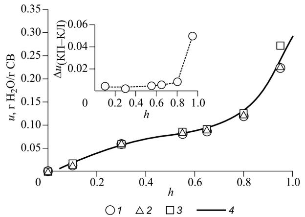
**Рис. 1.** Изотермы сорбции воды корой лиственницы (1), сосны (2), пихты (3) и аппроксимирующая все данные «обобщенная» изотерма сорбции (4). На врезке показана зависимость разности равновесного водосодержания коры пихты и лиственницы от относительной влажности среды  $h$ .
