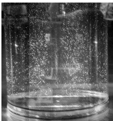
Рис. 2. Пример визуализации частицами нейтральной плавучести.
