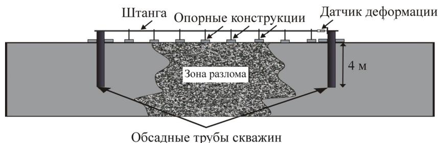
Рис. 3. Устройство пункта деформационного мониторинга
