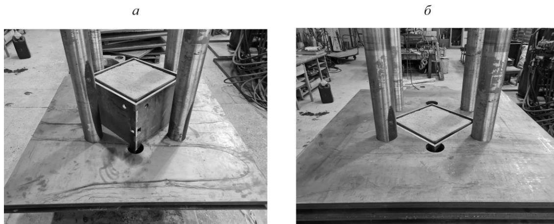
Рис. 2. Фотографии крупноразмерного образца в испытательной камере (а) и смонтированных плит силового контура (б)
