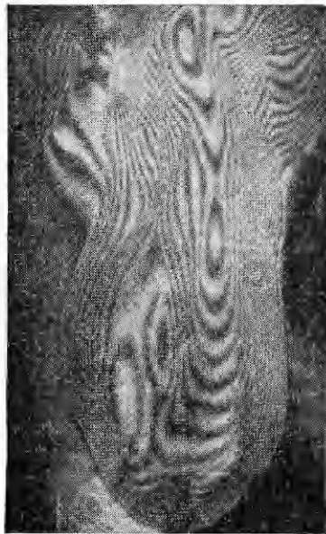
Рис. 3. Интерферограмма процесса горения модельной смеси (30% полимеризованного углеводородного горючего, 70% перхлората аммония) с дисперсностью окислителя 80 \cdot 10^{-5} м.
