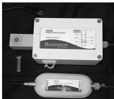
Рис. 2. Малогабаритный измеритель магнитной восприимчивости MS2 с измерителем MS2G
