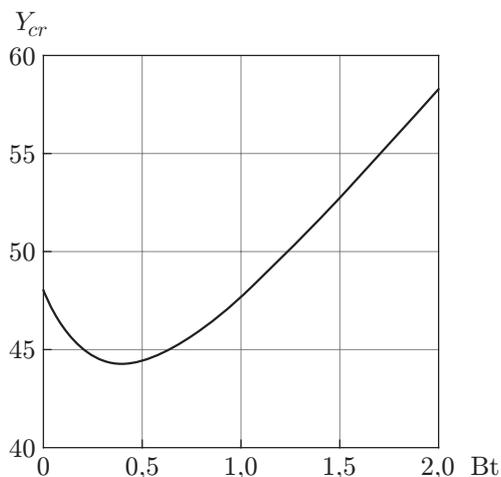
Рис. 3. Зависимость критической плотности электрического тока, при которой происходит бифуркация вращения, от числа Бэтчелора
