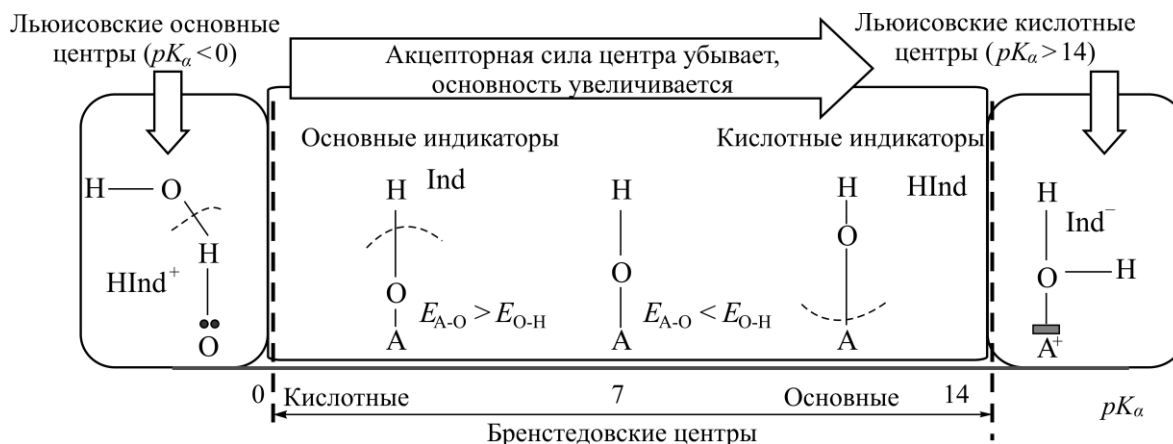
Рис. 1. Схема кислотно-основных центров частично гидратированной поверхности твердого тела
