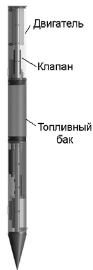
Рис. 9. Схема двигателя, работающего на топливе на основе HAN
