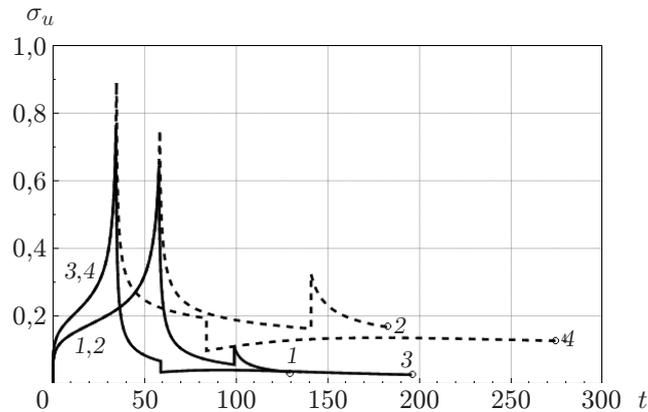
Рис. 5. Зависимость интенсивности напряжений в свободной части мембраны от времени в случае кусочно-постоянного нагружения (обозначения те же, что на рис. 4)
