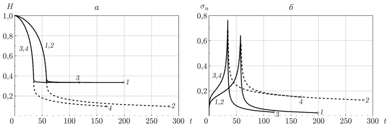
Рис. 4. Зависимости толщины мембраны (а) и интенсивности напряжений в свободной части мембраны (б) от времени в случае постоянного нагружения: 1, 2 —  $\dot{q} = 0,5 \cdot 10^{-4}$ , 3, 4 —  $\dot{q} = 10^{-4}$ ; 1, 3 — контактные условия идеального скольжения (сплошные линии), 2, 4 — условия прилипания (штриховые линии)
