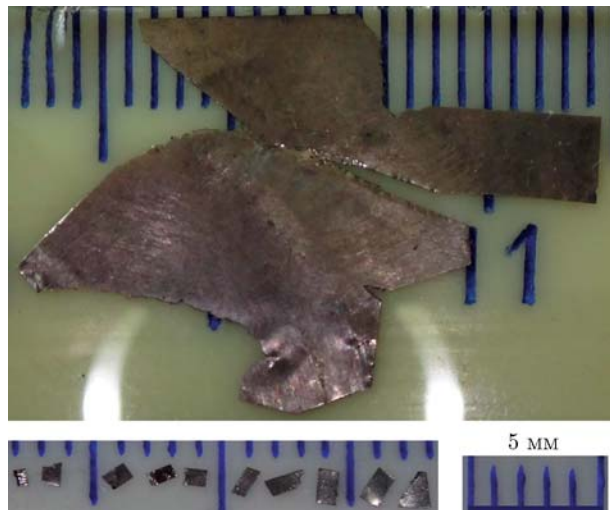
Рис. 2. Титановый «лепесток» и отрезанные от него частицы-включения для одного опыта
