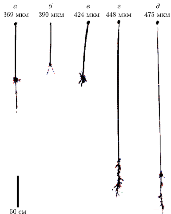
Рис. 10. Разнообразие картин фрагментации горящих в воздухе частиц титана (скорость съемки 500 кадр/с):
