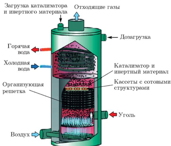
Рис. 1. Схема реактора с псевдооживленным слоем
