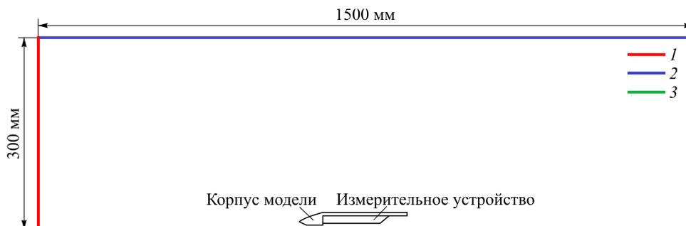
Рис. 5. Расчетная область для численного решения задачи обтекания.
