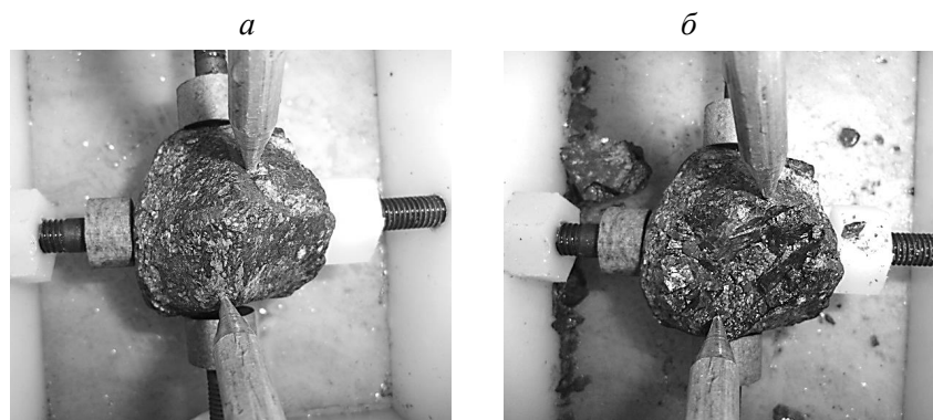
Рис. 2. Дробление крупного кристалла граната в пробойнике: а — кристалл граната до ЭИ-воздействия; б — откольная воронка на поверхности кристалла граната после ЭИ-воздействия
