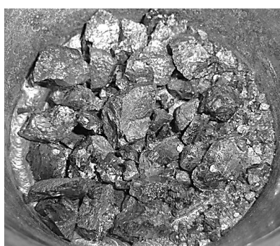
Рис. 3. Продукт измельчения граната в дезинтеграционной камере
