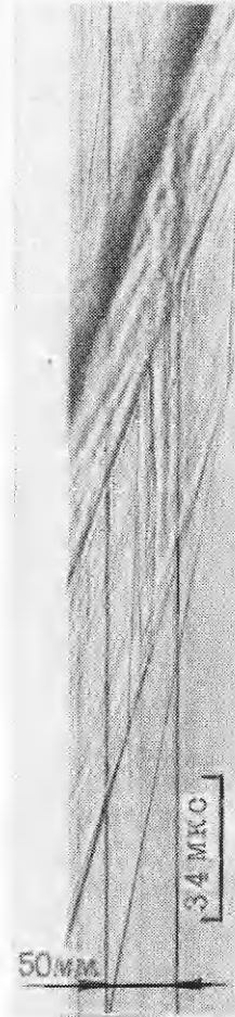
Рис. 4. Волновая картина до перехода горения в детонацию. Образование комплекса головная волна — фронт пламени.
