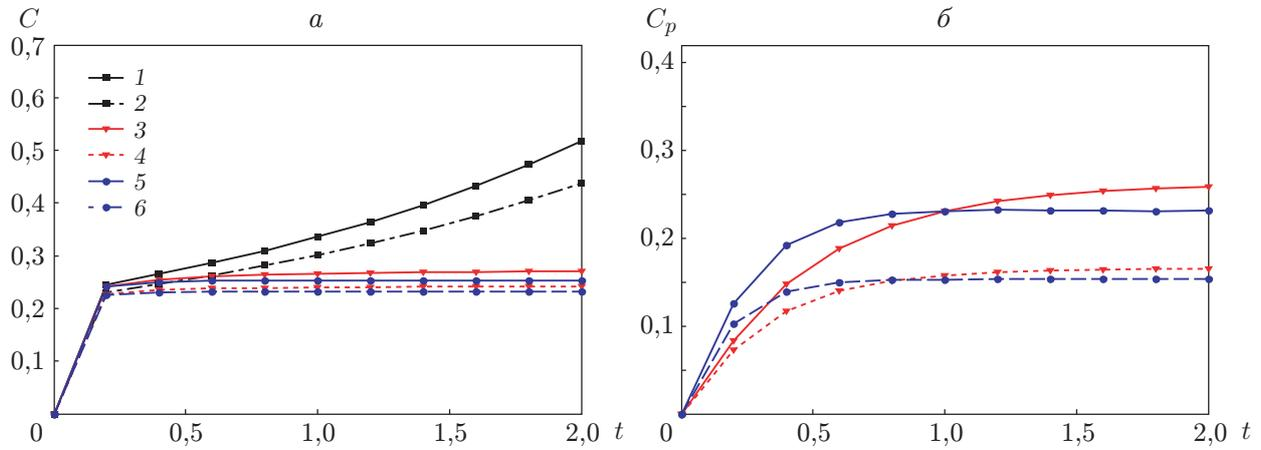
Рис. 5. Зависимости коэффициентов поверхностного трения жидкости (а) и фазы частиц (б) от времени при различных значениях  $M$  и  $\beta$ :
