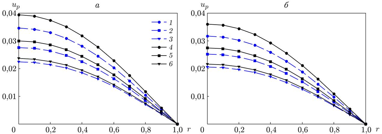
Рис. 4. Распределения скорости частиц пыли при  $\beta = 0,5$  и различных значениях  $M, t, \tau_D$  (обозначения те же, что на рис. 3)
