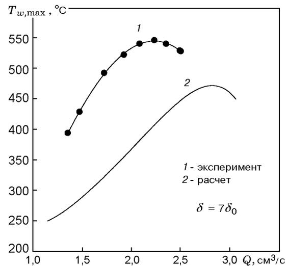
Рис. 3. Зависимость максимальной температуры стенки от расхода горючего газа
