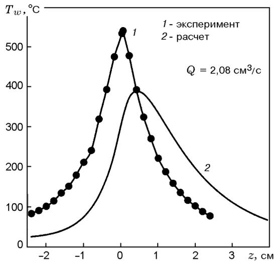
Рис. 2. Профили температуры тепловой волны в стенке трубки
