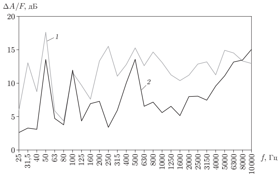
Рис. 3. Зависимости уменьшения входной вибровозбудимости (1) и звукового давления (2) от частоты для ВПП 6
