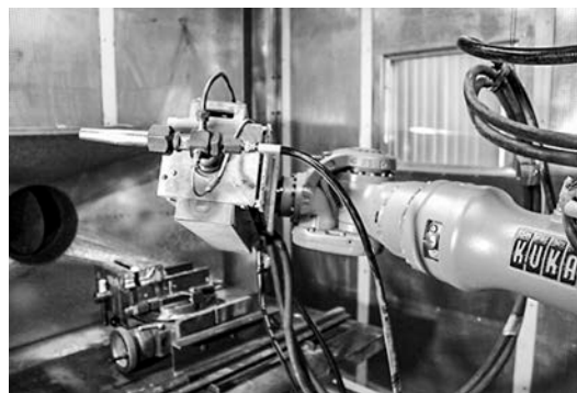
Рис. 1. Нагреватель и сопловой узел на роботе-манипуляторе в камере напыления.
