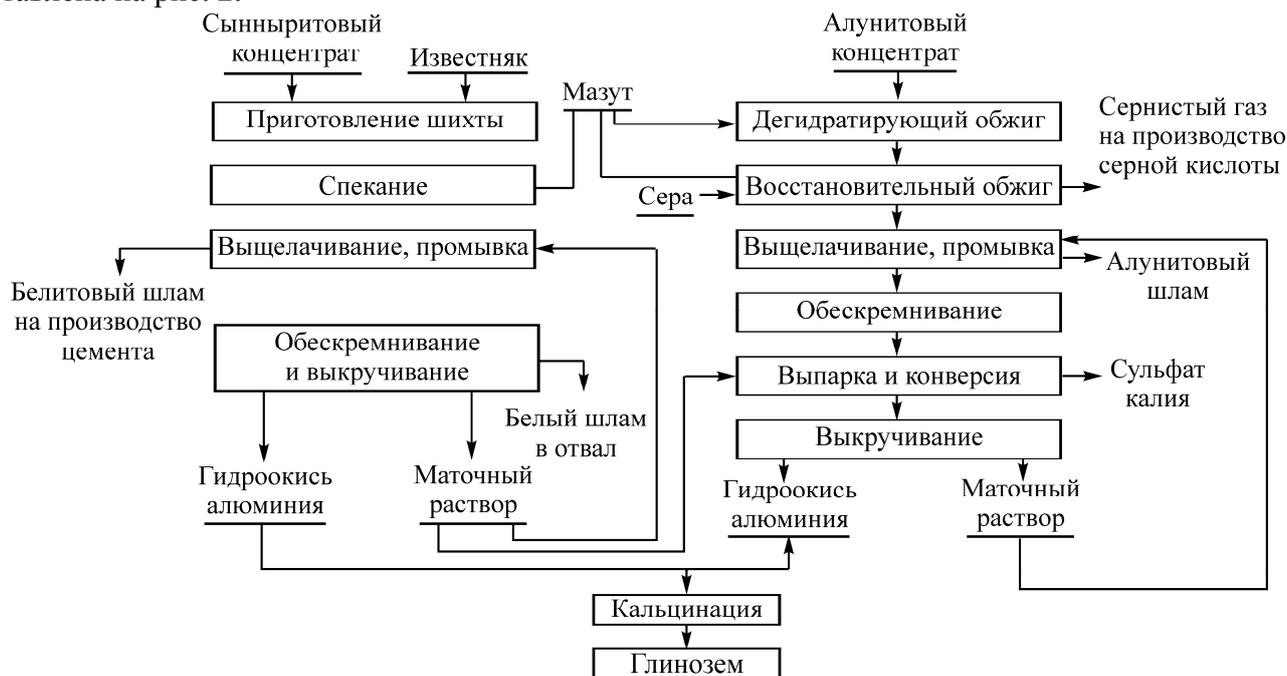
Рис. 2. Общая технологическая схема переработки алунитового и сынныритового концентратов
