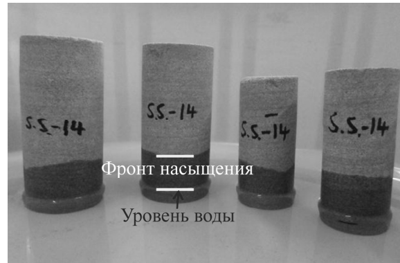
Рис. 1. Расположение кернов для полного водонасыщения с применением метода постепенного насыщения. Фронт водонасыщения постепенно продвигается к вершине керна
