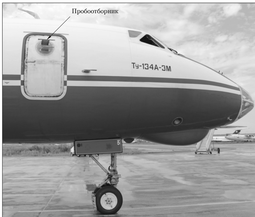
Рис. 1. Размещение пробоотборника аэрозоля на самолете-лаборатории Ту-134 «Оптик»
