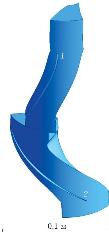
Рис. 1. Область расчета параметров течения в завихрителе:
