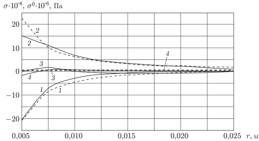
Рис. 2. Зависимости компонент тензора напряжений от радиуса в кольце из КС1, находящемся под действием внутреннего давления ( $\varphi = 30^\circ$ ):
