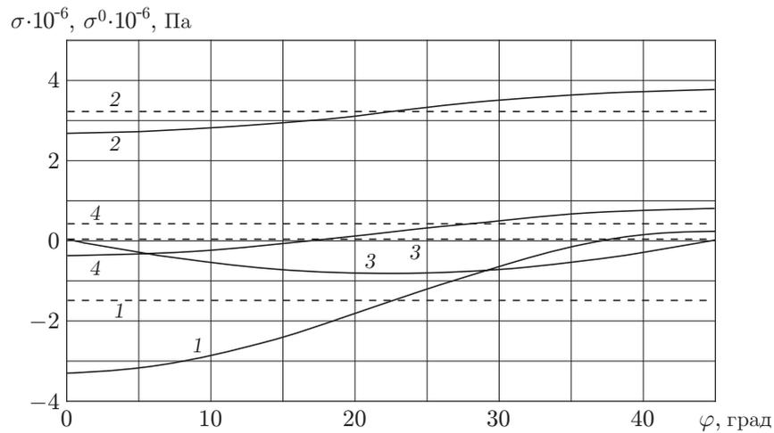
Рис. 3. Зависимости компонент тензора напряжений от угловой координаты в кольце из КС1, находящемся под действием внутреннего давления ( $r = 0,015$  м) (обозначения те же, что на рис. 2)
