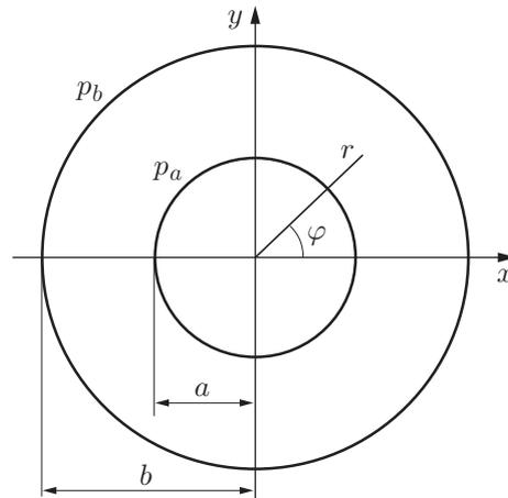
Рис. 1. Упругое анизотропное кольцо под действием внутреннего  $p_a$  и внешнего  $p_b$  давлений
