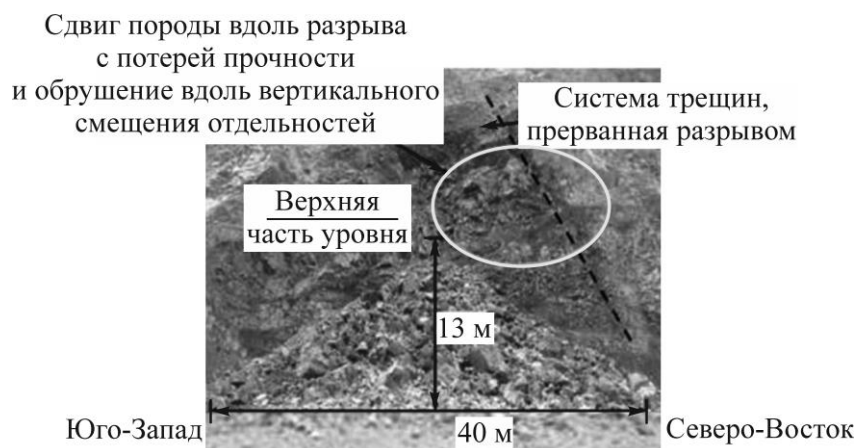
Рис. 4. Предполагаемый обвал с указанием ориентации и отдельностей
