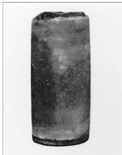
Рис. 5. Внешний вид образца, сгоревшего в оболочке
