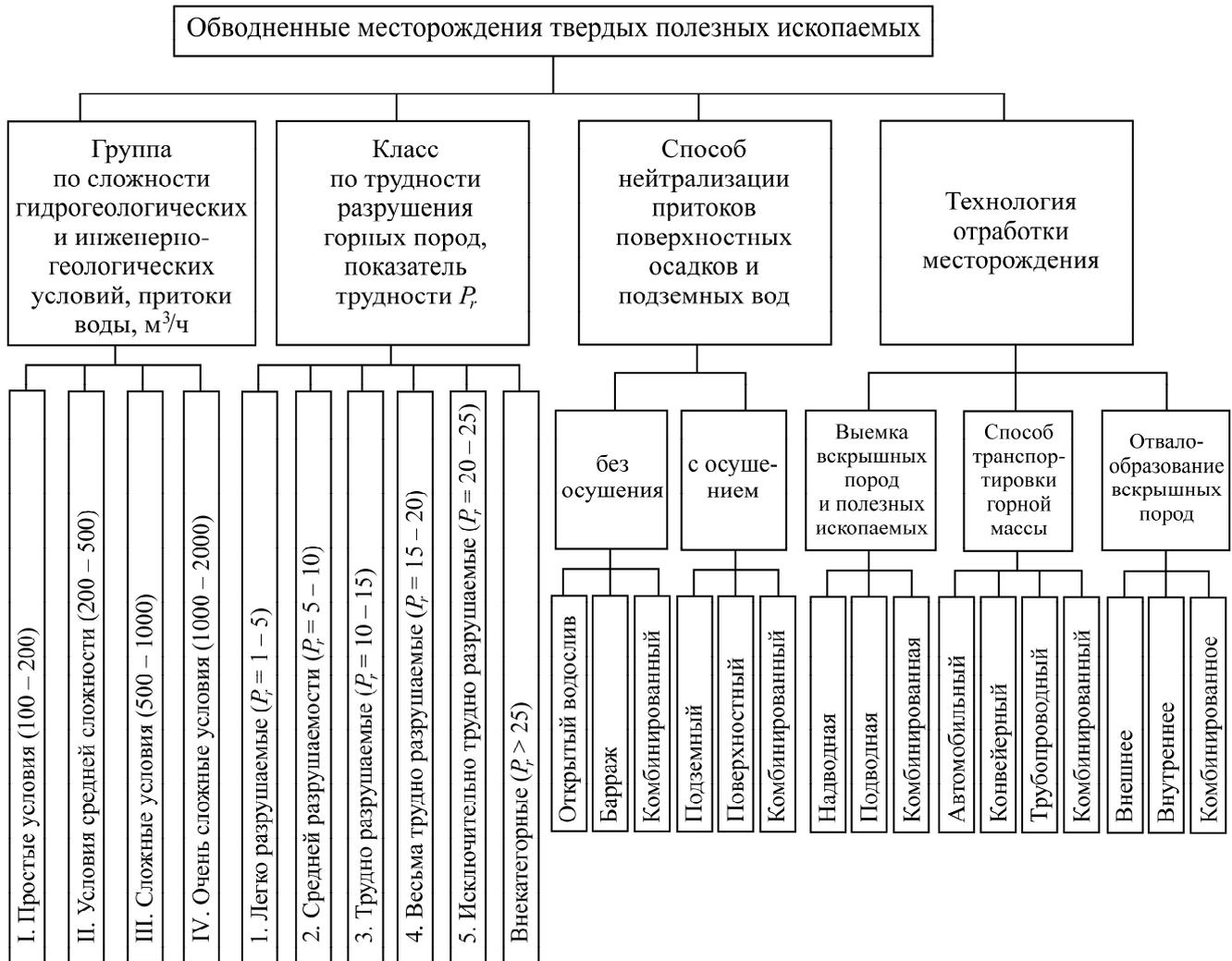
Рис. 2. Структура составляющих систематизации обводненных месторождений твердых полезных ископаемых
