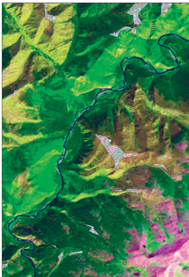
Рис. 5. Классы пикселей, окрашенные в разные цвета, в местоположении 5-22 на спутниковом снимке Landsat 8 (фрагмент).
