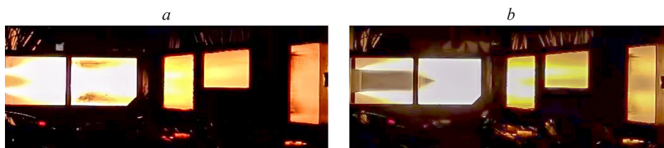
Рис. 15. Визуализация пламени при 90-градусной (a) и 45-градусной (b) подаче топлива.
