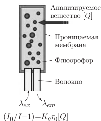
Рис. 2. Интраартериальный микросенсор (справа), основанный на флюоресцентном поглощении (слева)
