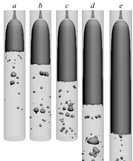
Рис. 4. Расчетная межфазная поверхность для разных длин стационарного газового снаряда. 27 (a), 43 (b), 55 (c) 79 (d), 105 (e) мм.
