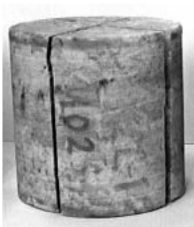
Рис. 6. Направления разрушения на образцах известняка
