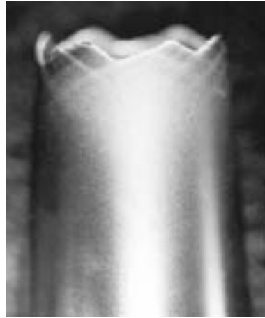
Рис. 5. Направления разрушения на образцах из стали 12ХНЗА
