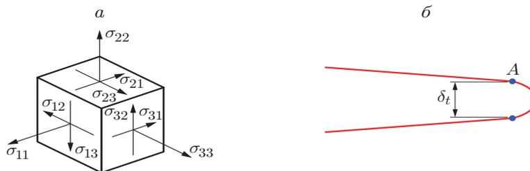
Рис. 1. Напряжения, при которых происходит раскрытие трещины (а), и смещения точек в окрестности вершины трещины (б) ( $A$  — точка, в которой проводится измерение напряжения  $\sigma_{22}$  и смещения  $\delta_t$ )
